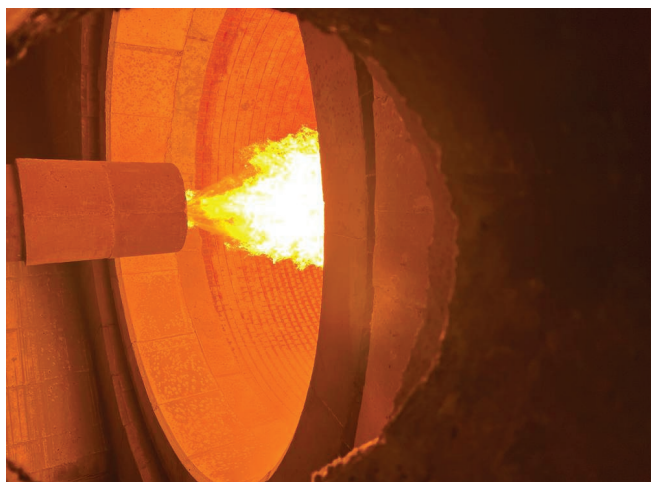
Nowoczesny piec obrotowy ma wydajności 3 700 ton na dobę.
